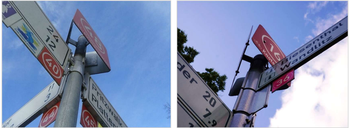
Abbildung 34: Mögliche Ausgestaltungsformen von Knotenpunkthüten bei Pfeilwegweisern: Einteiliger Knotenpunkthut (links: Prignitz; Foto: Büro Radschlag GbR); Dreiteiliger Knotenpunkthut (rechts: Barnim; Foto: IGS mbH)
